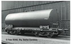
Vorbild: Privat-Einheitskesselwagen mit Bremserbühne Bauart Uerdingen des United States Transportation Corps. Eingestellt bei der Deutschen Bundesbahn um 1955.
